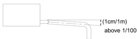
Figura 6.1 Panta minimă necesară a conductelor de scurgere
