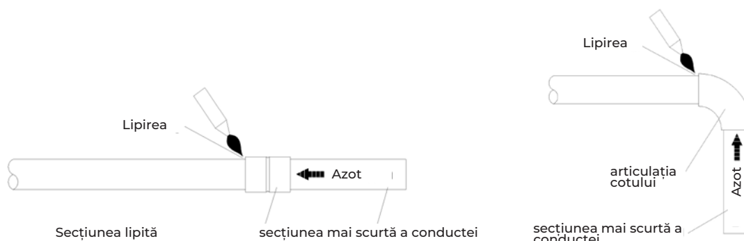
Figura 5.5 Curgerea azotului din partea mai scurtă în timpul lipirii
